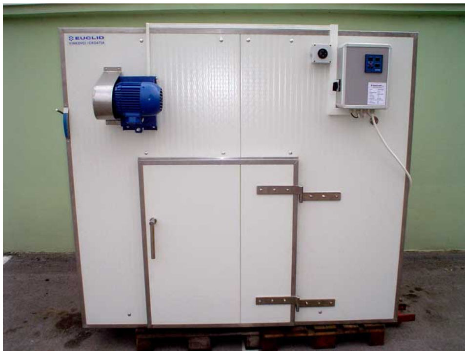
Слика 1. Сушара за сушење воћа
