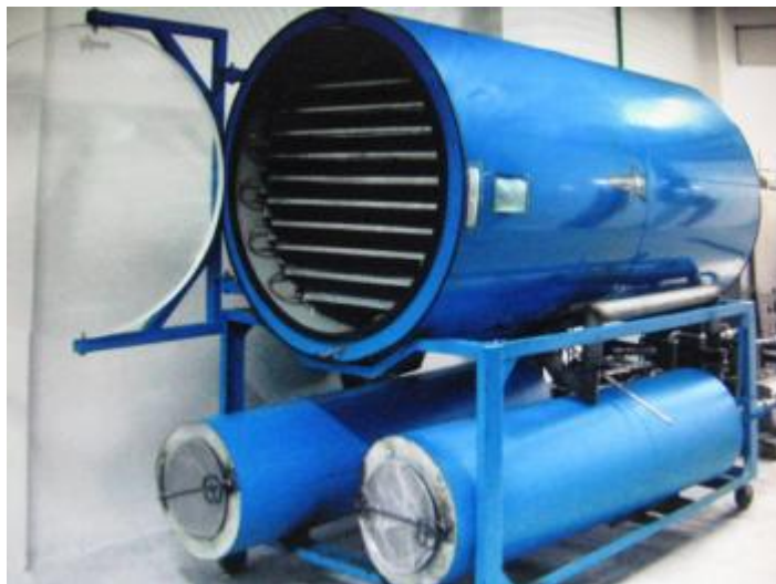
Слика 12. Уређај за лиофилизацију
