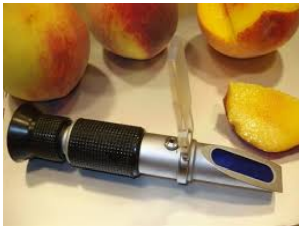
Слика 3. Рефрактометар за мерење шећера у воћу
